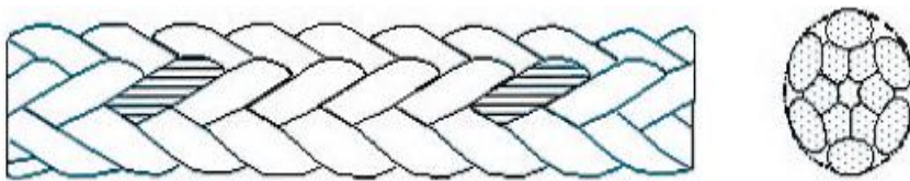
شکل ۳- شمای طناب ۸ رشته ای گیس باف (نوع L)
