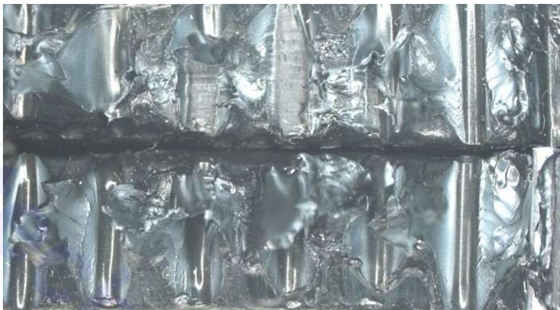
شکل ۵- شکست شکل پذیر نوعی بین سیم‌ها- نما از سطح شکست
