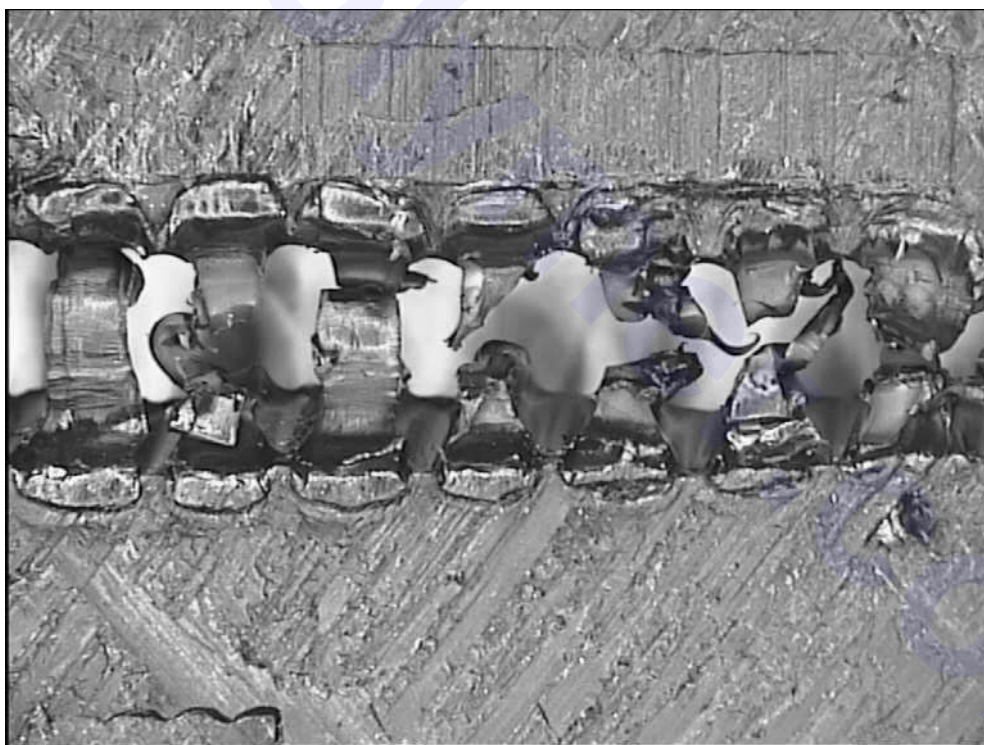
شکل ۶- شکست شکل پذیر نوعی بین سیم‌ها- از نمای کنار
